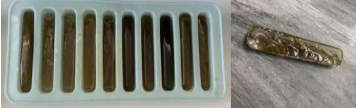
Figura 17. Moldes de material compuesto de fibra reforzado
