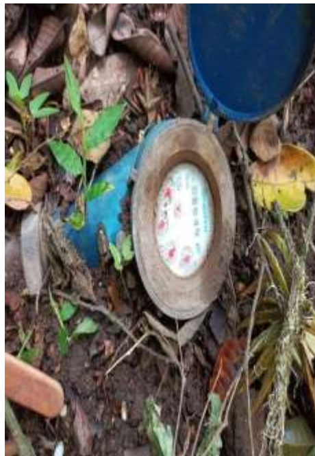
Figura 11. Sistema de macro medición instalado en las granjas Diamante I y II.
