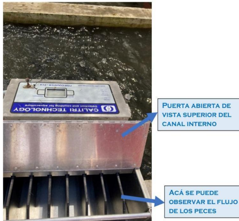
Figura 11: Vista superior del canal interno
