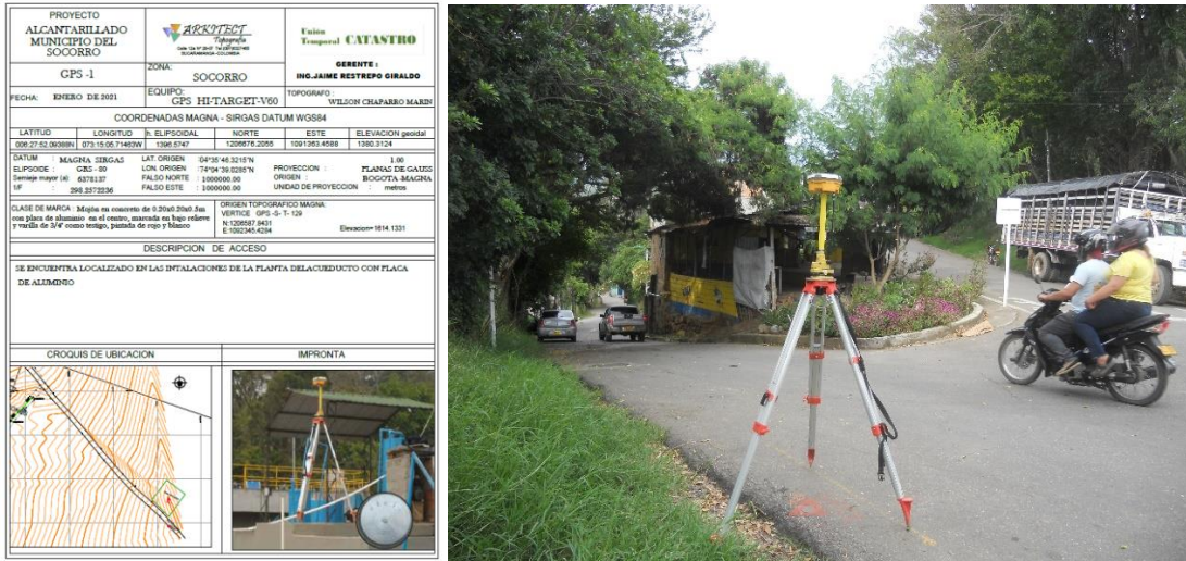
Figura 10. Ficha y punto geodésico.
