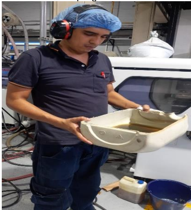
Figura 14 Posición para transportar el aceite hacia el cuarto de sustancias peligrosas
