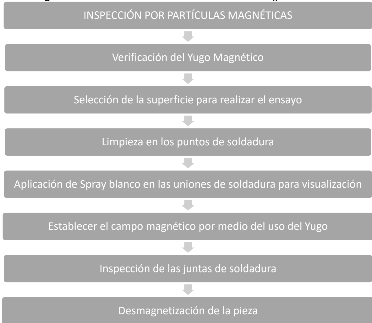
Figura 25. Procedimiento Realización END Partículas Magnéticas
