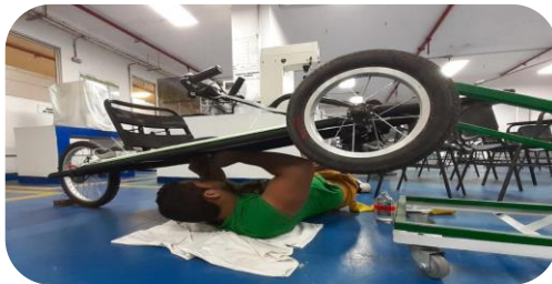
Paso 3: Lijar las uniones soldadas para remover restos usando grata o lija
