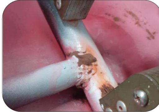
Figura 23. Inspección uniones soldadas luego de finalizar END Partículas Magnéticas.
