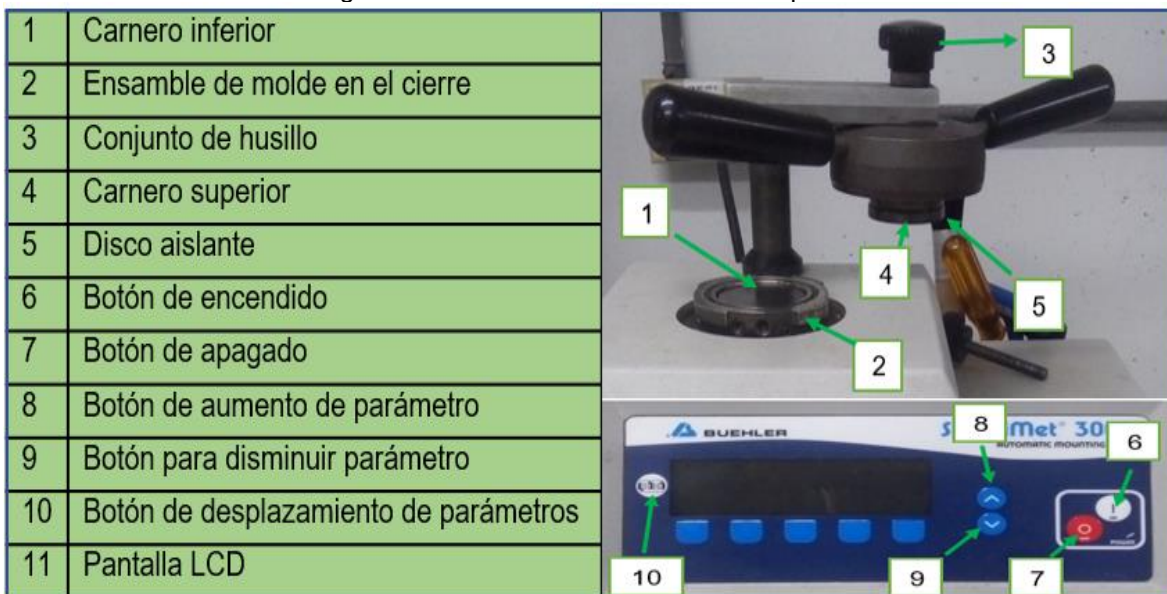
Figura 3. Partes de la montadora de baquelita.
