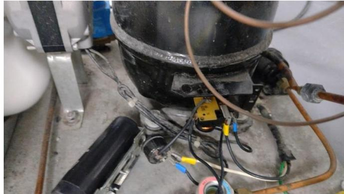
Imagen 13. Conexión del térmico
