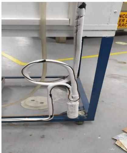
Imagen 8. Escarcha presente en la tubería.
