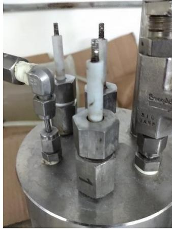
La porta electrodos deben estar fabricados en acero inoxidable T316 que finalmente realizará el apriete de la pieza a la tapa del reactor y evitará el desgaste del PTFE que ocasione caídas de presión durante el ensayo. Se deben disponer de tres portas electrodos y electrodos. Son electrodos de referencia, auxiliar y de trabajo el cual presentará la corrosión. El material de fabricación de los electrodos de referencia y auxiliar debe ser inoxidable ya que no debe aportar electrones a la reacción.
