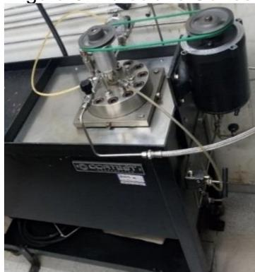
Posteriormente se indica como se arma el vaso, lugar donde se insertan los cupones o muestras que serán efecto de estudio después de realizar la prueba. Se detalla en el manual las especificaciones del vaso, instalación y desarmado del mismo para futura limpieza, se indica el torque aplicado a la tornillería que realizará el sellado del equipo.
