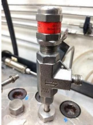
Las válvulas de presión presentan el inconveniente que en caso de accionar en operación debido a condiciones de alta presión su escape se hace directamente en el lugar de trabajo. Esto podría causar graves consecuencias al operador si llegase a encontrarse junto al equipo en caso de falla.
