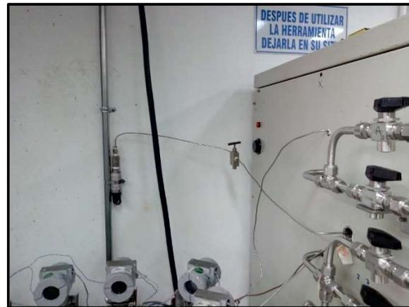
(d) Válvula de inyección de Nitrógeno
