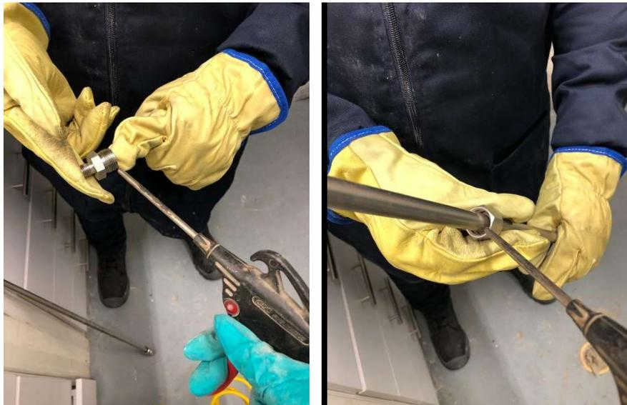
Figura 61. Limpieza del desempaquetado
