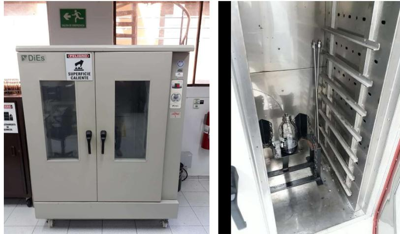
Figura 56. Secado de arena del tubing en horno DiEs
