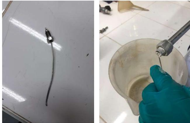
Figura 58. Raspado de arena en el extremo del tubing
