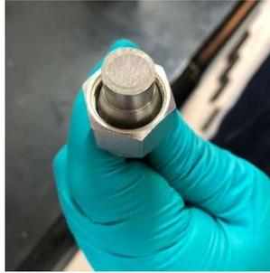
Figura 48. Postura de malla de filtración en tubing
