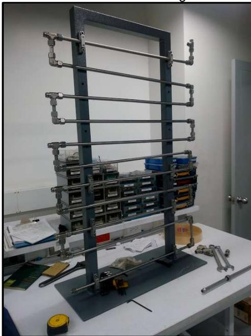
(a) Slimtube en proceso de ajuste en mantenimiento
