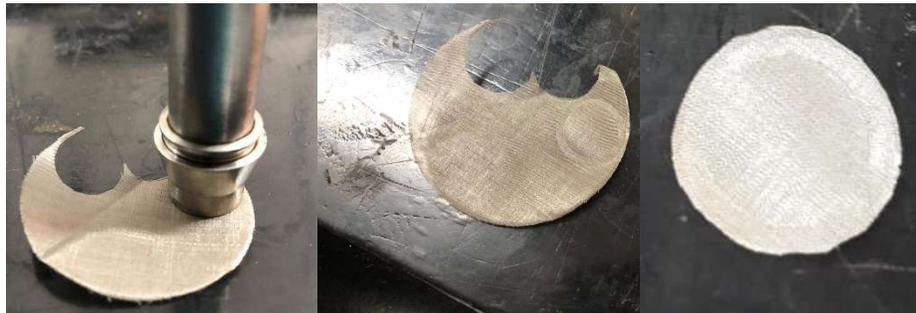
Figura 47. Corte de malla de filtración
