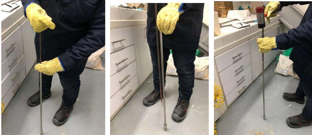
Figura 51. Compactado de tubing
