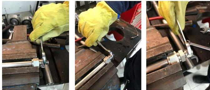
Figura 49. Postura de unión reductora en tubing
