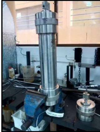
(a) Sujetar en una prensa
