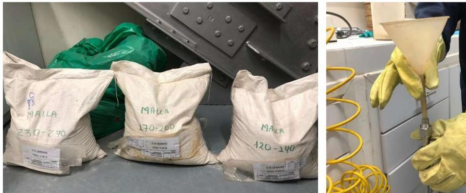
Figura 50. Tipos de arena y disposición del llenado de tubing
