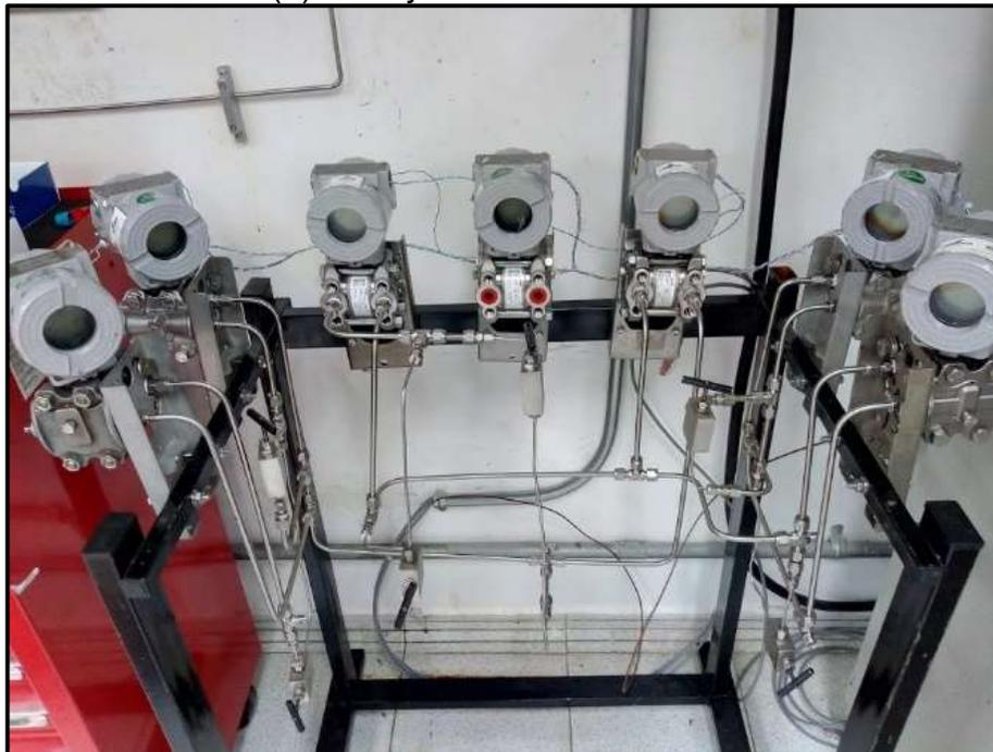
(c) Banco de instrumentación de medición de presión
