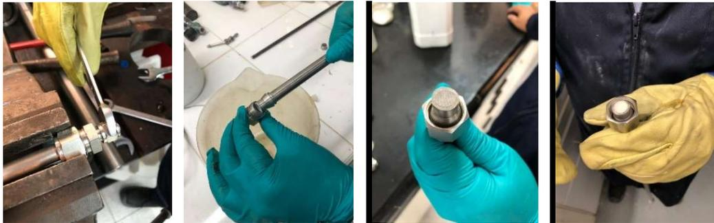
Figura 57. Montaje del tubing en la zaranda
