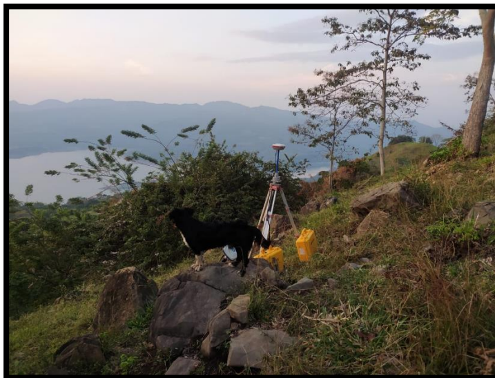
Figura 3. Posicionamiento del equipo para amarre a la red geodésica.
