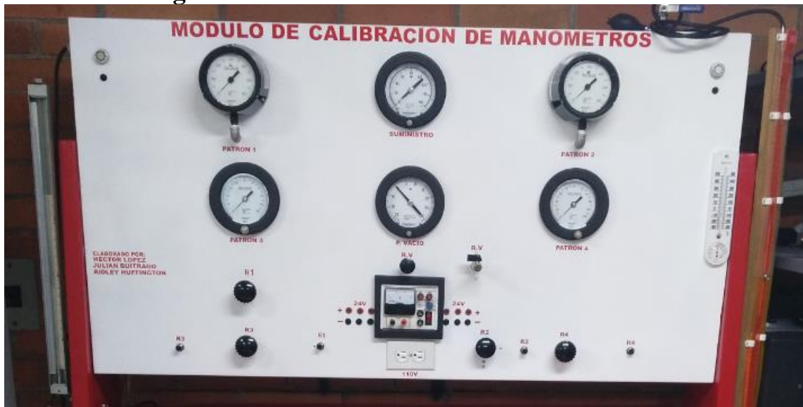
Imagen XIX Módulo de calibración de manómetros.
