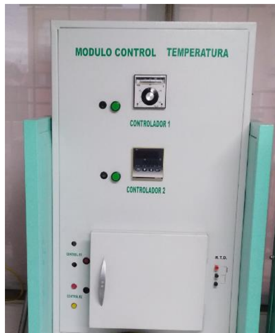
Imagen XXV: Módulo de control de temperatura
