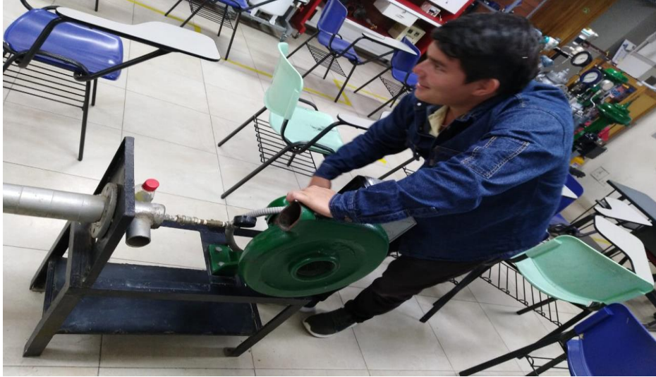
Imagen V: Mantenimiento de la bomba tipo caracol
