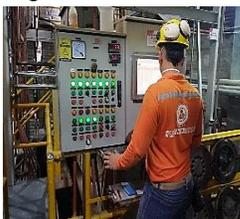
Si el producto va aceitado el operario de extrusión enciende el sistema y registra los datos de la etiqueta entregada por el operario de molienda dependiendo de la cantidad de aceite según formulación.
