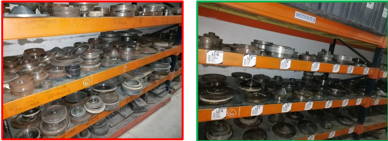
Figura 19 Área de almacenamiento de moldes después de las 5s
