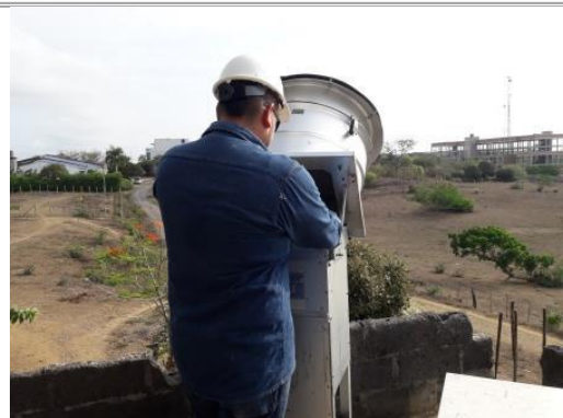
CAMBIO DE FILTROS DEL EQUIPO
