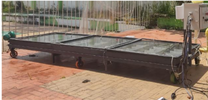
Figura 4. Colector solar plano dispuesto para pruebas.
