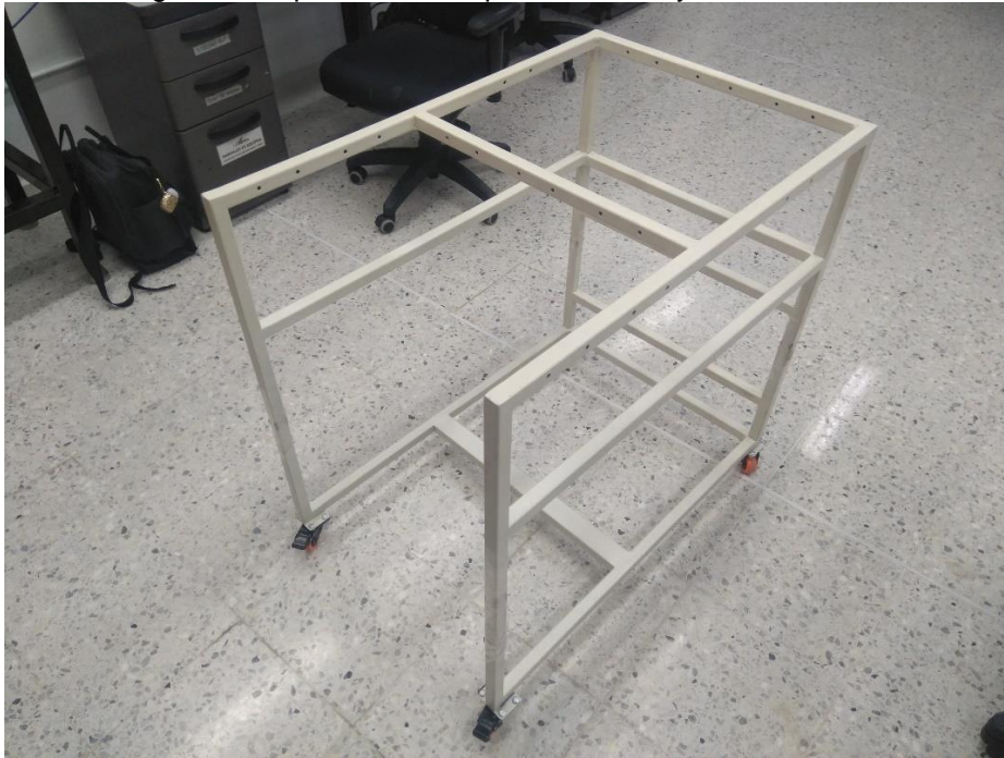
Figura 29 Soporte en físico para sensores y electroválvulas
