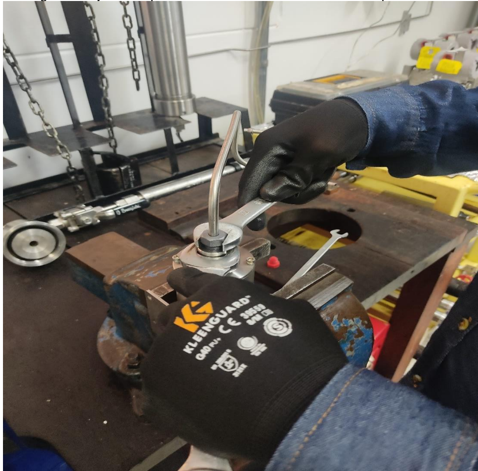
Figura 36 Ajuste acople de electroválvulas con conectores tipo autoclave
