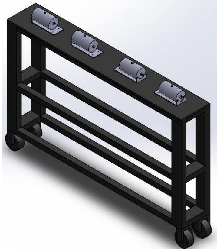
Figura 17 Soporte de electroválvulas para tomas de muestra
