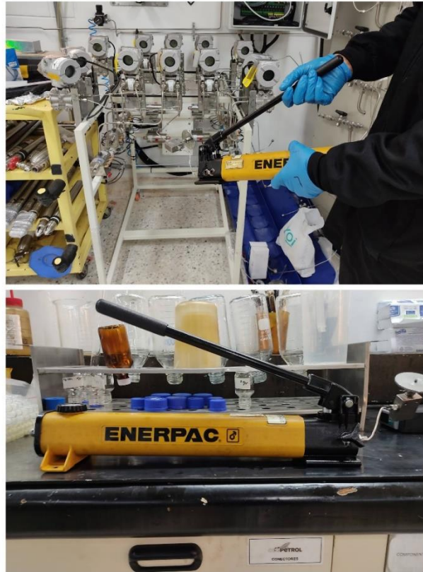
Figura 74 Inyección de aceite mineral con bomba manual Enerpac
