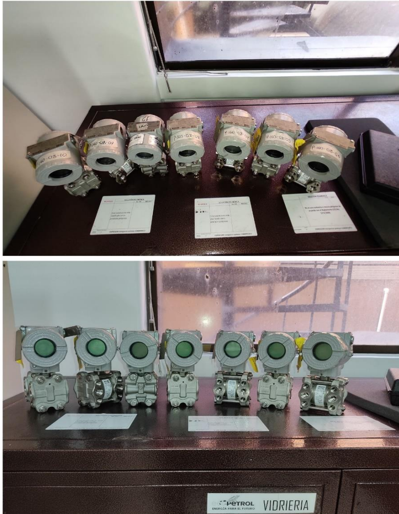
Figura 54 Equipos Smar calibrados
