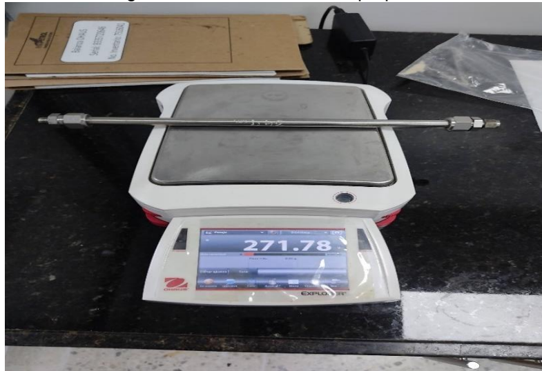
Figura 73 Peso final tramo empaquetado
